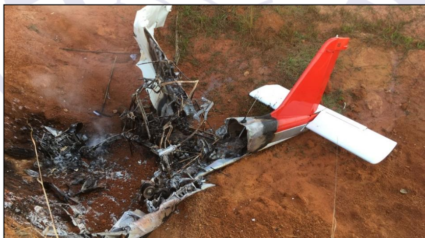
Figura 2 - Aeronave no ponto de impacto, após o incêndio.
