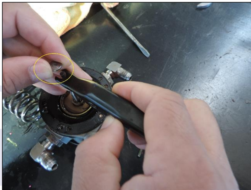
Figura 2 - Eixo de acionamento do diafragma rompido por fadiga de material.
