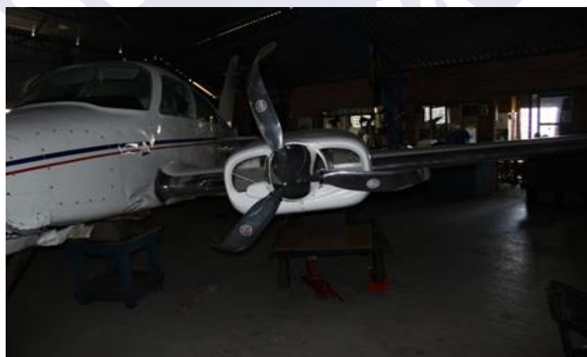
Figura 4 - Danos à hélice esquerda.
