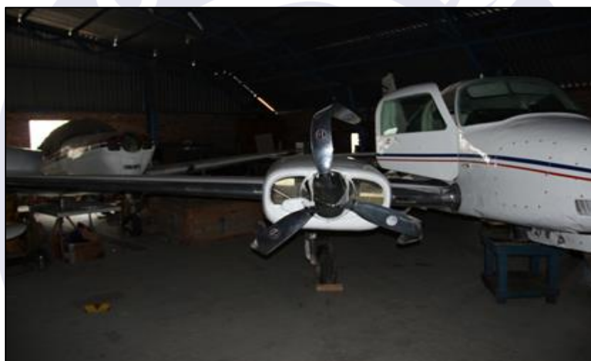
Figura 3 - Danos à hélice direita.
