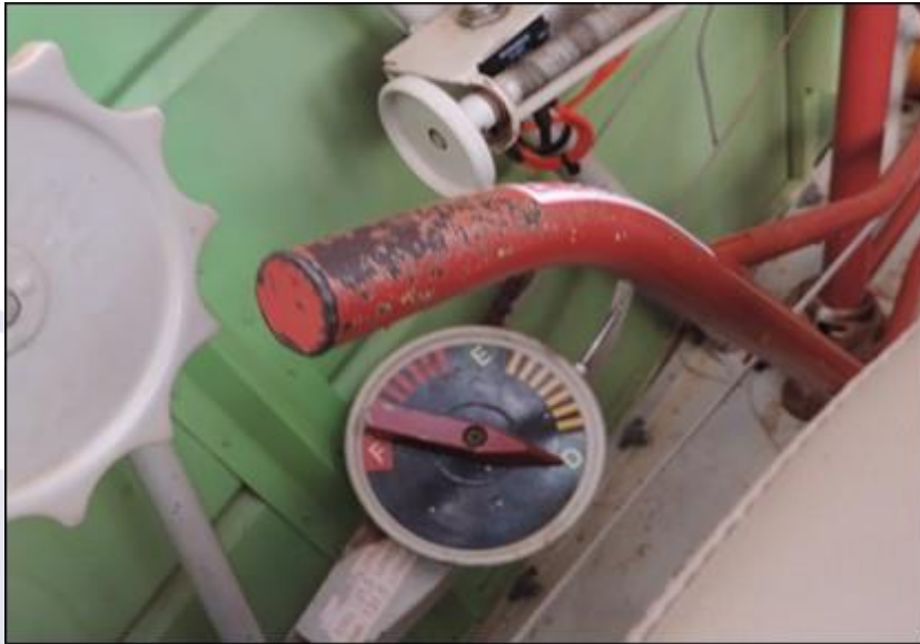
Figura 3 - Posição encontrada da seletora de combustível após a ocorrência.
