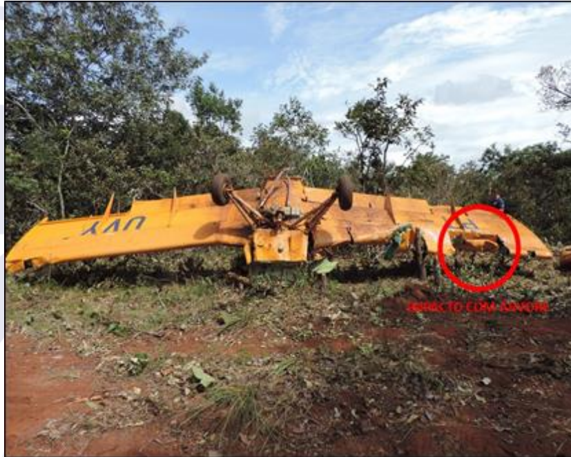
Figura 2 - Marcas do impacto contra árvore.
