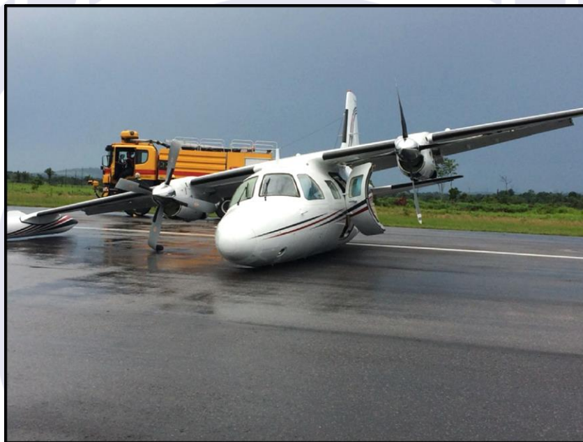
Figura 1 - Posição final da aeronave com o trem de pouso recolhido.
