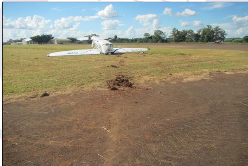
Figura 2 - Marcas deixadas pelo spinner no solo após a quebra do TPA.
