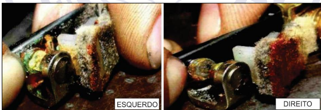
Figura 2 - Platinados dos magnetos contaminados (carbonização e azinhavre).
