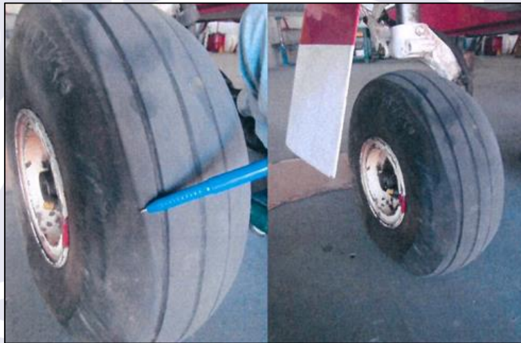
Figura 3 - Marcas de desgaste excessivo na lateral da banda de rodagem do pneu da roda do trem de pouso principal direito.
