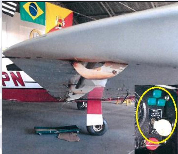
Figura 1 - Aeronave PT-EPN no solo apoiada no conjunto do trem de pouso, com destaque para a alavanca de comando na posição embaixo e travado, com as três luzes acessas.
