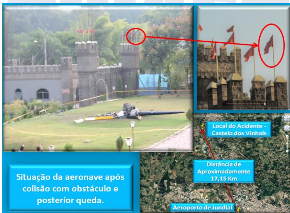
Figura 1 - Imagem da aeronave acidentada, obstáculo da colisão e trajeto percorrido.
