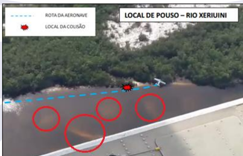
Figura 1 - Croqui do acidente. Os círculos vermelhos indicam pontos em que era possível identificar o fundo do rio.
