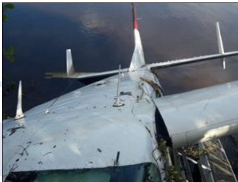
Figura 3 - Detalhe do dano à raiz da asa esquerda.
