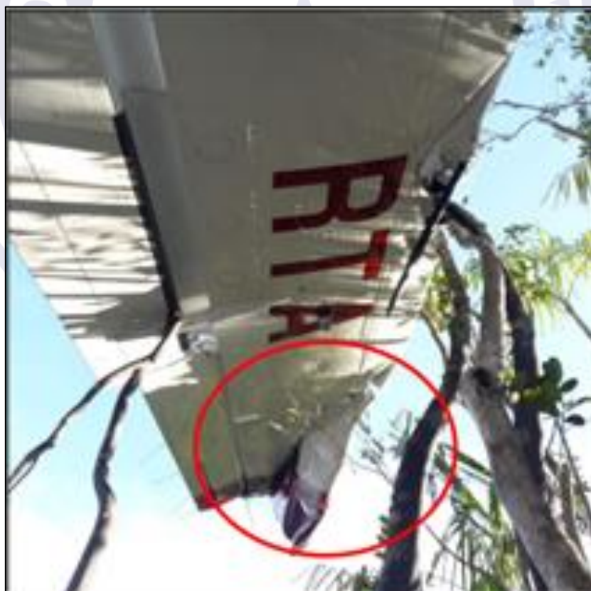
Figura 2 - Vista dos danos na asa esquerda.
