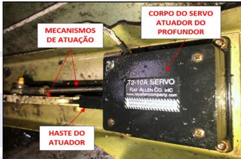
Figura 6 - Servo atuador do compensador do profundor.
