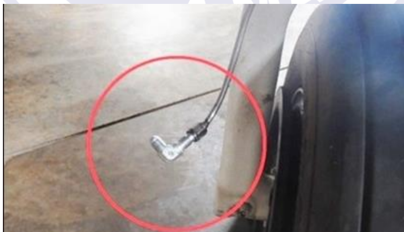
Figura 6 - Isolamento da linha de pressão do conjunto de freio direito.
