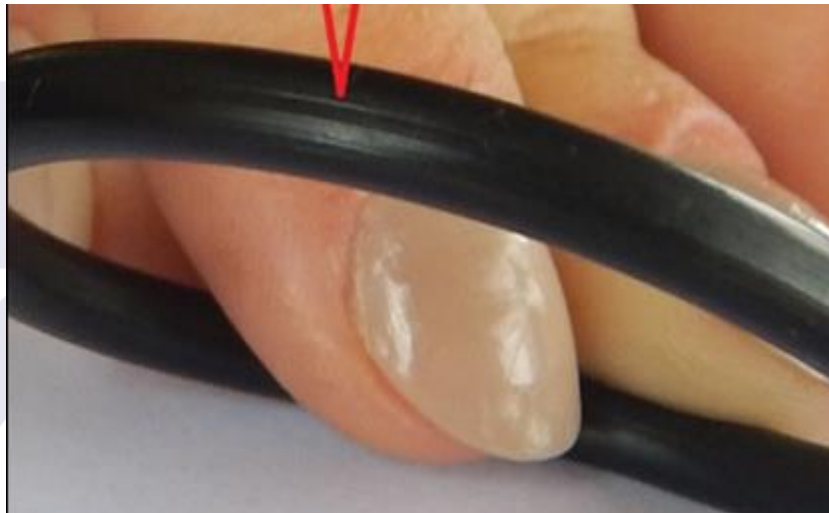
Figura 7 - Gaxeta com destaque para os sinais de desgaste.
