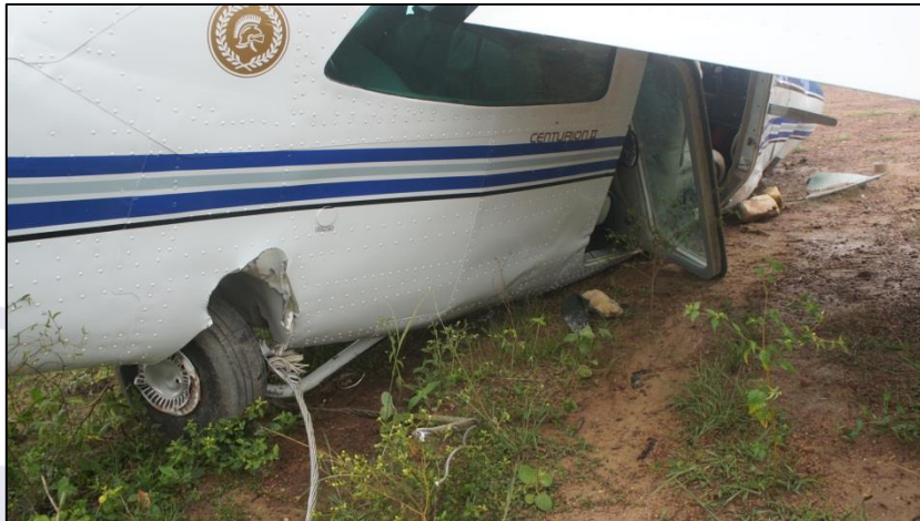
Figura 2 - Aeronave após a colisão, com cabos de transmissão de energia elétrica enganchados no trem de pouso principal direito.
