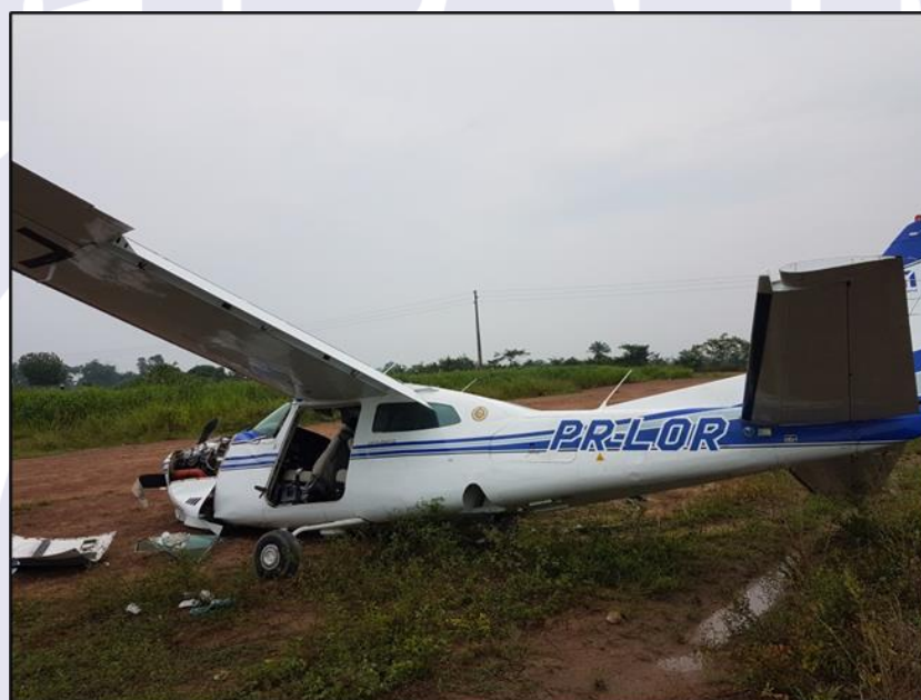
Figura 1 - Posição da aeronave após o acidente. Ao fundo a linha de transmissão da rede elétrica contra a qual a aeronave colidiu.
