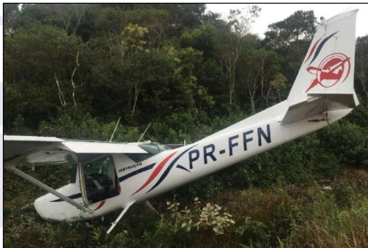
Figura 1 - Vista geral do PR-FFN após a saída de pista ( veer off ).
