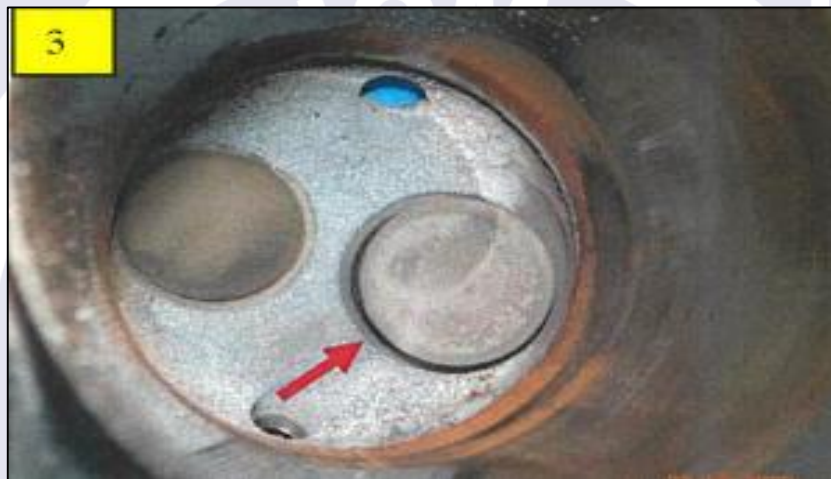
Figura 4 - Vista do cilindro 3 com a válvula de admissão solta.
