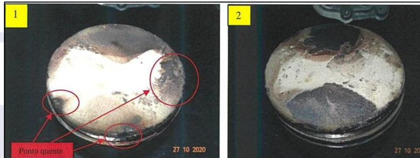
Figura 3 - Pistões dos cilindros 1 e 2, com destaque para os pontos quentes.
