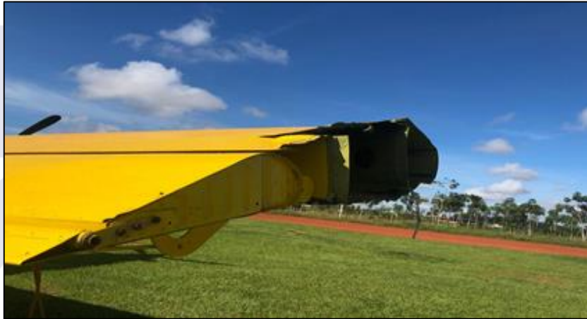
Figura 1 - Foto aproximada do dano na asa direita após o impacto.
