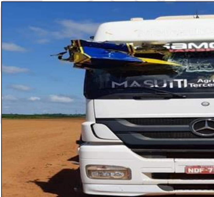
Figura 2 - Condição da carreta após o impacto da asa direita da aeronave.
