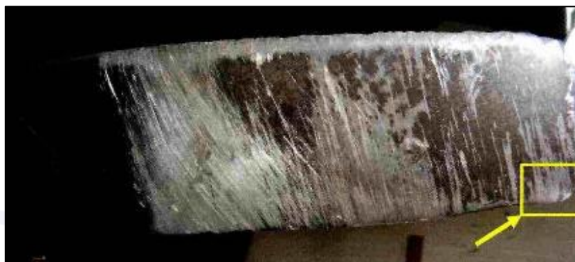
Figura 5 - Vista de uma pá da hélice mostrando os riscos transversais, marcas de impacto e dobramento voltado para frente.
