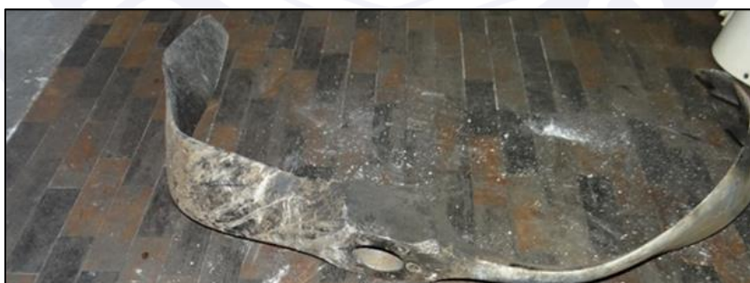
Figura 4 - Vista geral da hélice com as pontas das pás voltadas para trás.
