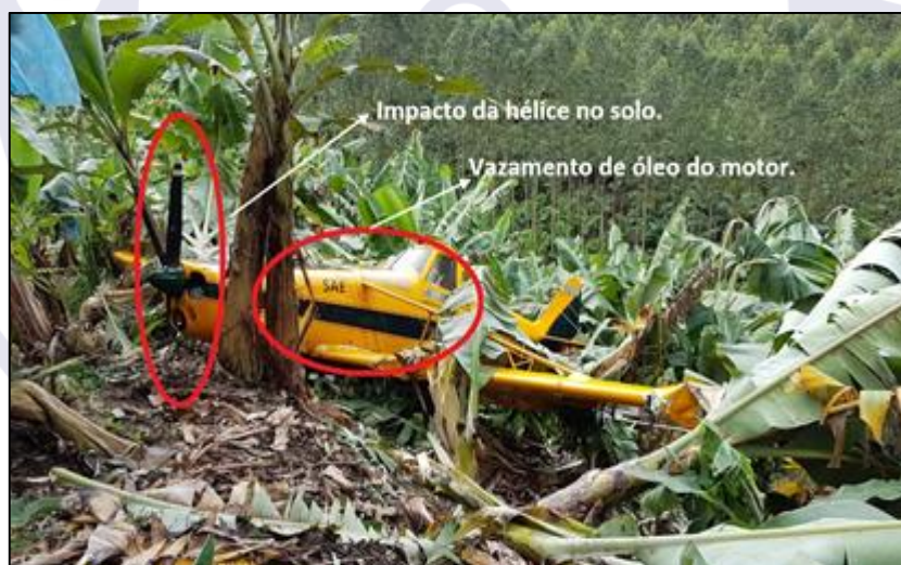
Figura 2 - Vista lateral esquerda com destaques para a hélice e o óleo do motor no capô da aeronave.
