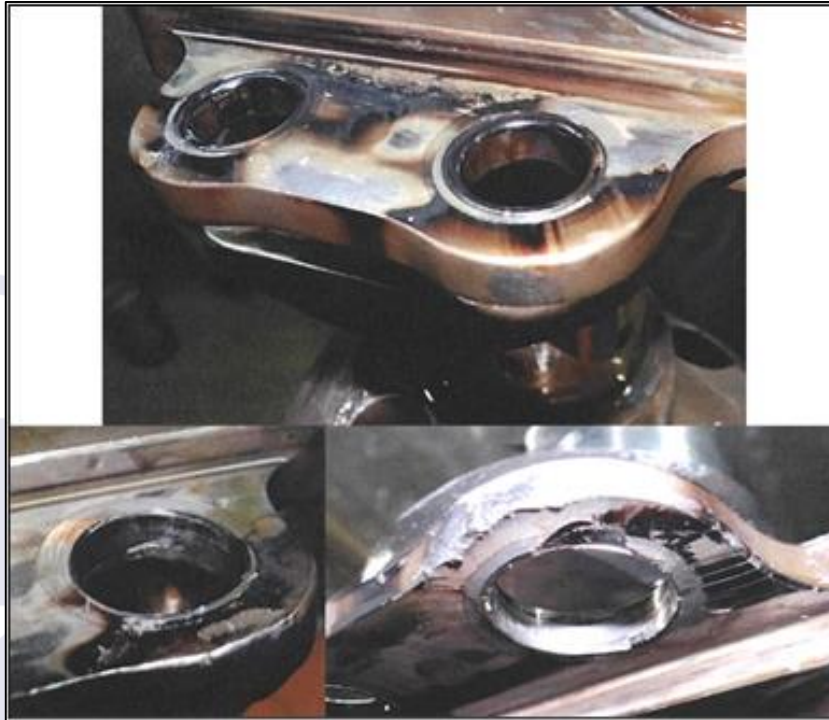
Figura 7 - Vista da aba mostrando o dano provocado pela saída da bucha.
