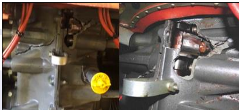
Figura 3 - Vista da fratura na parte superior do bloco do motor, altura dos cilindros 5 e 6.
