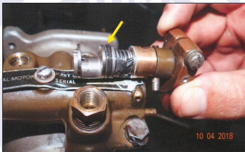
Figura 4 - Vista do anel de vedação ressecado.
