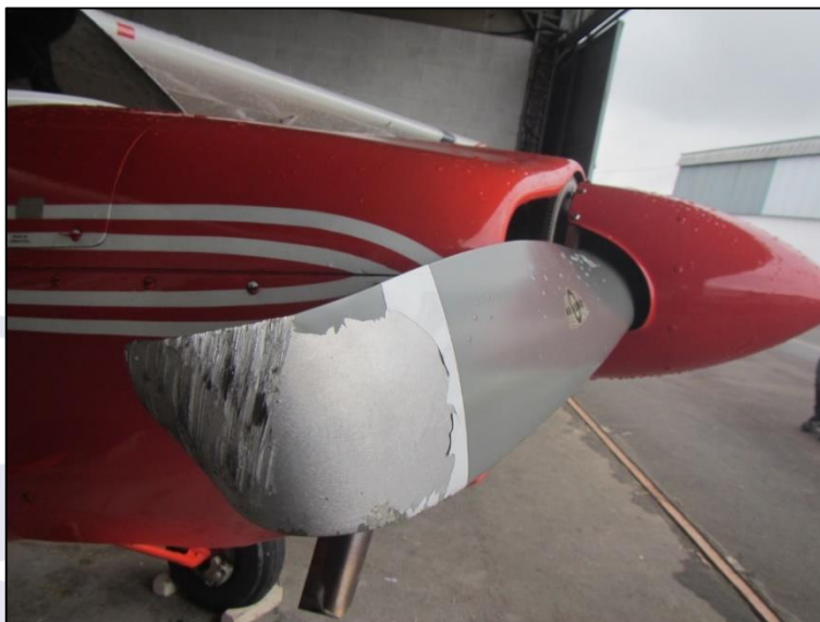
Figura 2 - Danos às pás da hélice e spinner .
