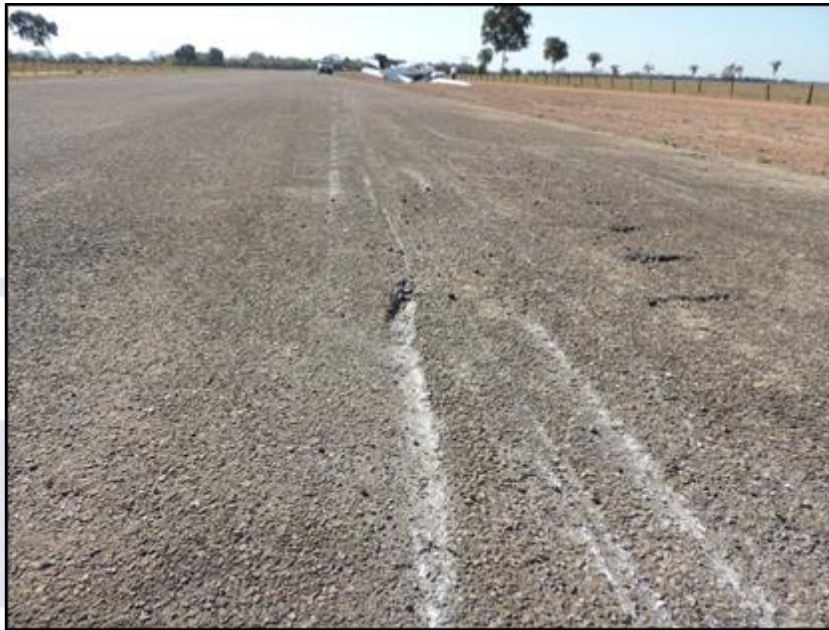
Figura 3 - Marcas observadas no ponto em que ocorreu o recolhimento do trem de pouso direito e contato da hélice com a pista.
