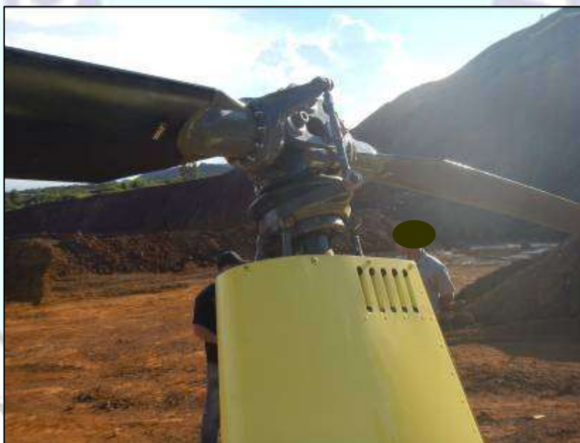
Figura 7 - Evidências de passo coletivo acentuado.
