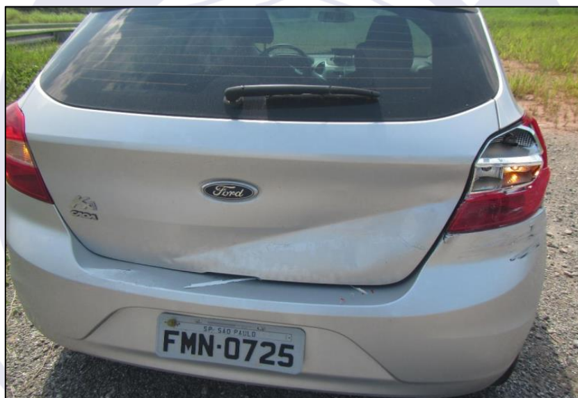
Figura 3 - Danos na parte traseira do veículo.
