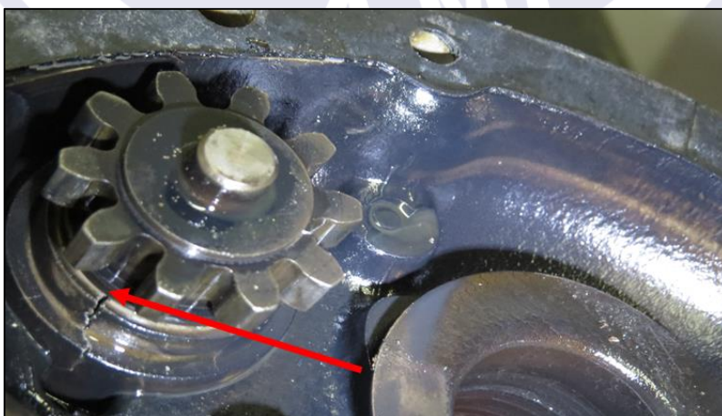
Figura 3 - Trinca no adaptador da bomba de vácuo.
