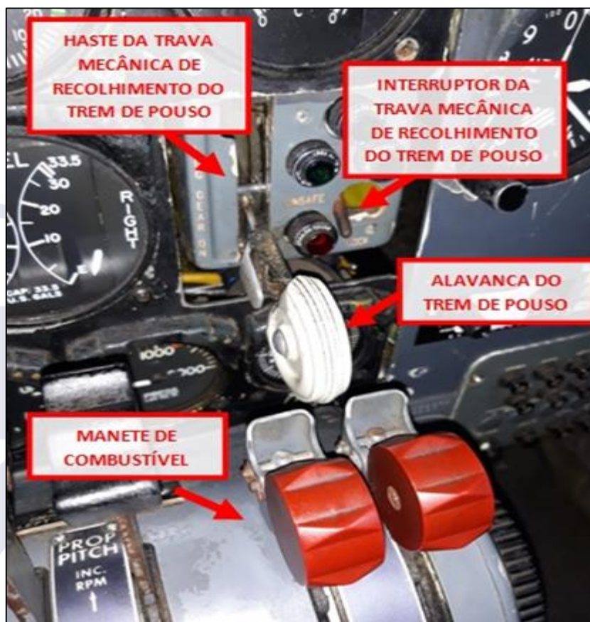
Figura 2 - Posição da alavanca do trem de pouso e do manete de combustível.
