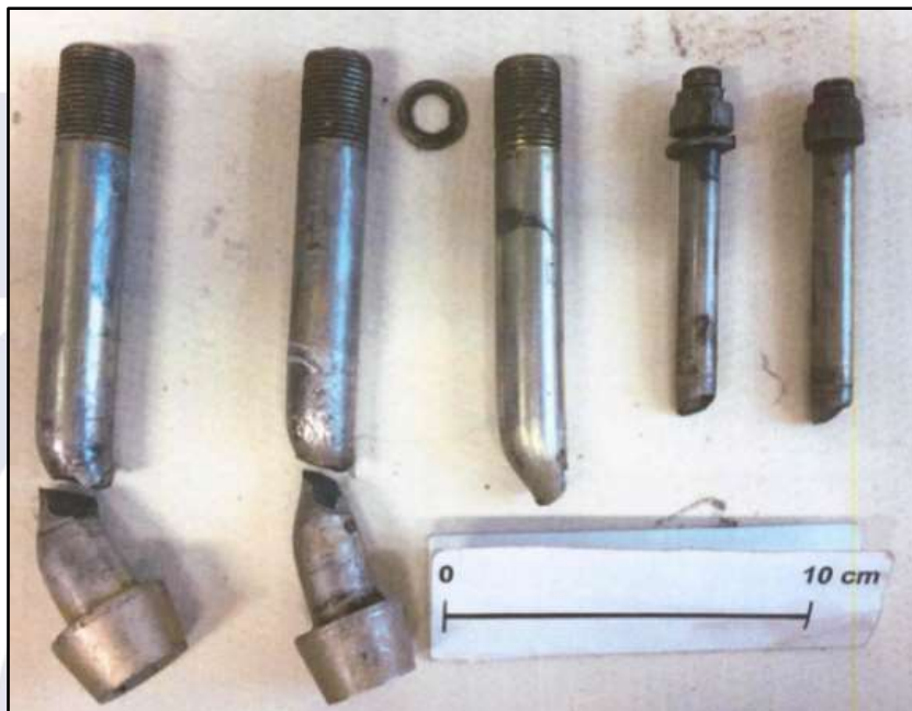
Figura 2 - Visão geral dos parafusos fraturados.
