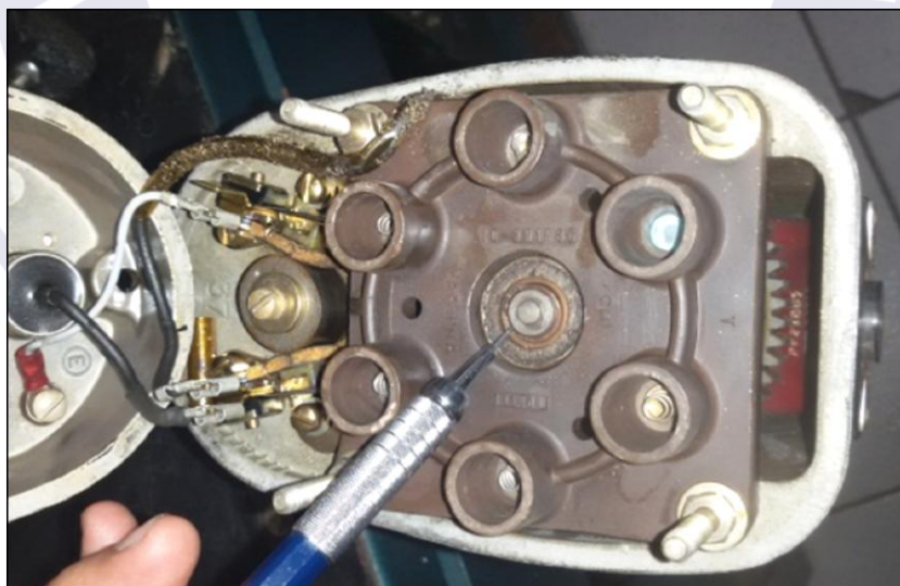
Figura 5 - Folga no eixo de acionamento do distribuidor.
