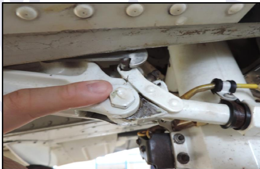
Figura 2 - Trava do trem principal esquerdo do PT-VSM, após a ocorrência, sem sinal de avaria.
