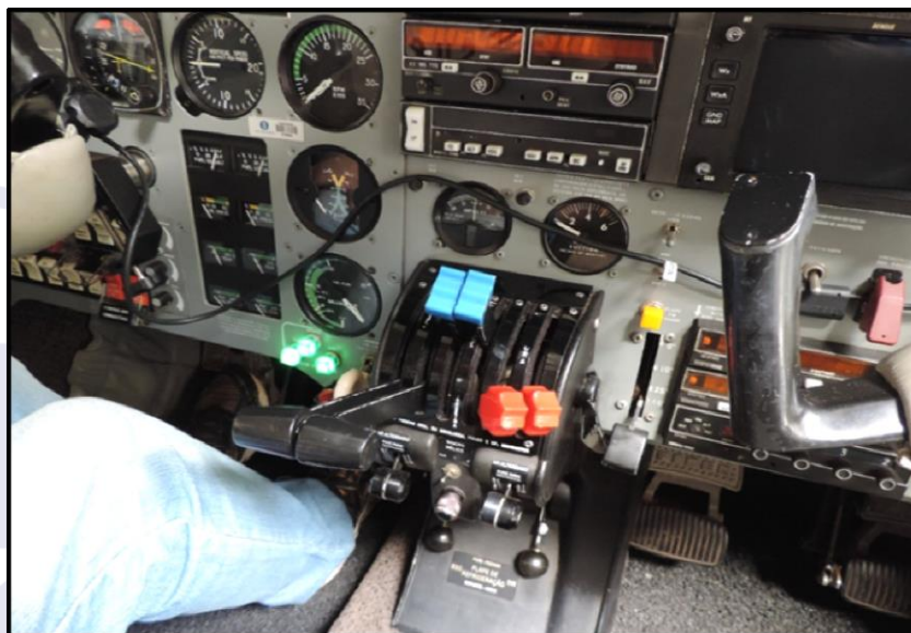
Figura 3 - Teste de funcionamento das luzes de indicação do trem de pouso.
