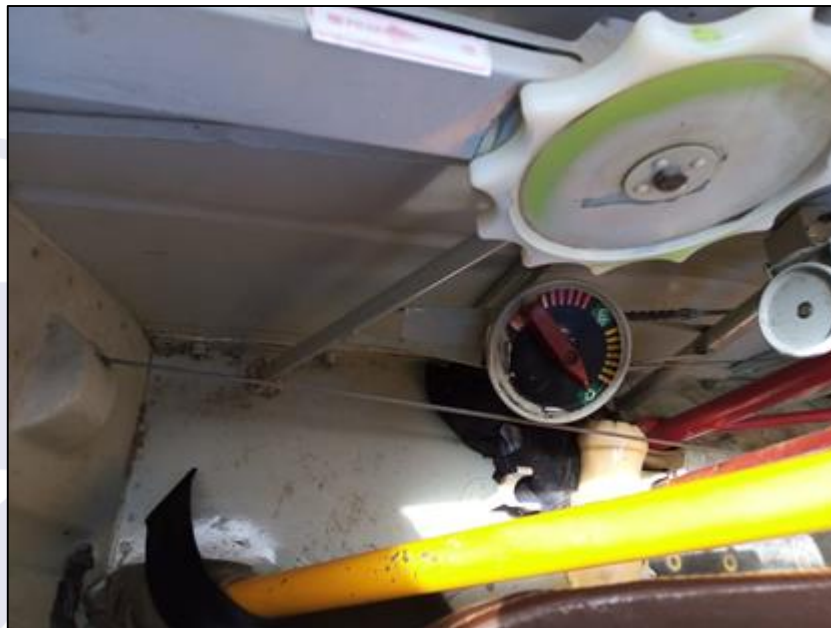
Figura 3 - Posição da seletora no tanque direito após o acidente.
