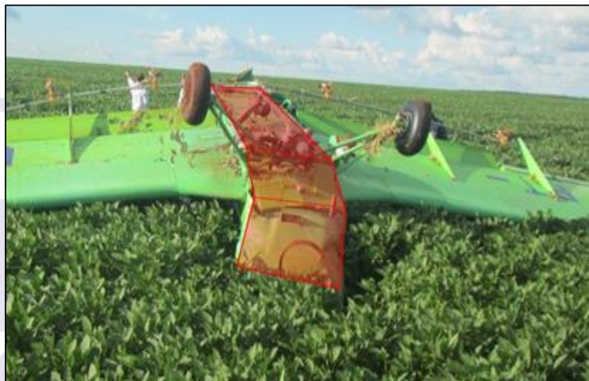
Figura 3 - Empenamento do eixo longitudinal observado no intradorso da aeronave.
