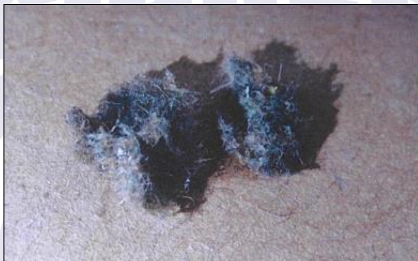
Figura 4 - Elemento contaminante do filtro.
