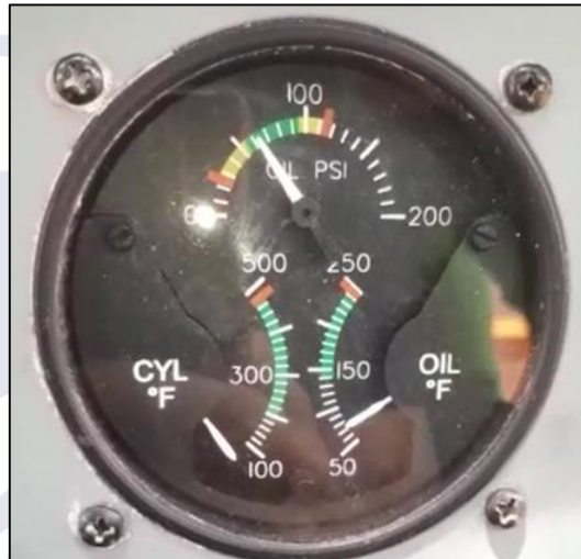
Figura 3 - Frame de vídeo de voo do PT-UJH sem indicação de temperatura da cabeça do cilindro e oscilações na temperatura do óleo do motor.
