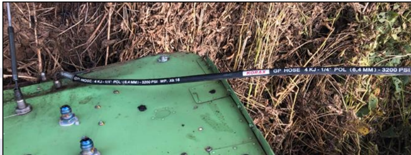
Figura 5 - Mangueira de uso não aeronáutico no Sistema de Combustível.
