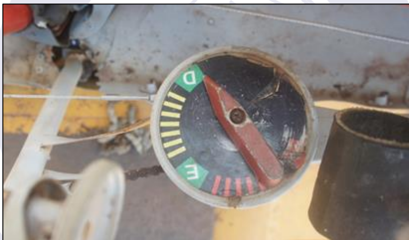
Figura 6- Indicação da Seletora de Combustível.
