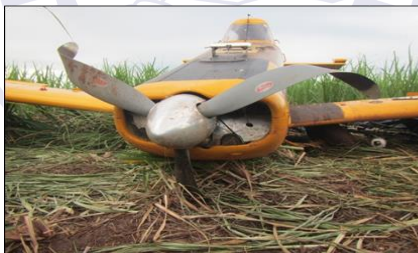
Figura 2 - Pás da hélice deformadas para trás, indicando baixa rotação do motor.
