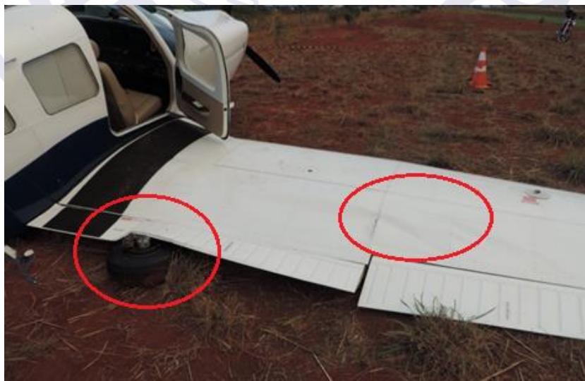
Figura 3 - Danos à aeronave, com destaque para o trem de pouso, flapes e a asa direita.
