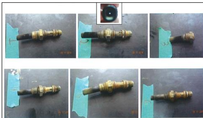
Figura 2 - Vista geral dos bicos injetores do motor. O detalhe mostra um dos bicos desobstruído, com passagem de combustível normal.
