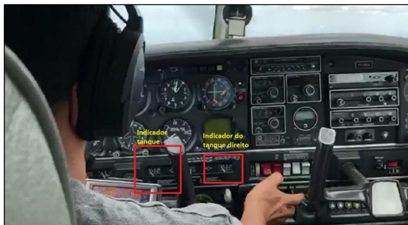
Figura 5 - Indicação de combustível (tanque esquerdo e tanque direito) durante o trecho 05.
