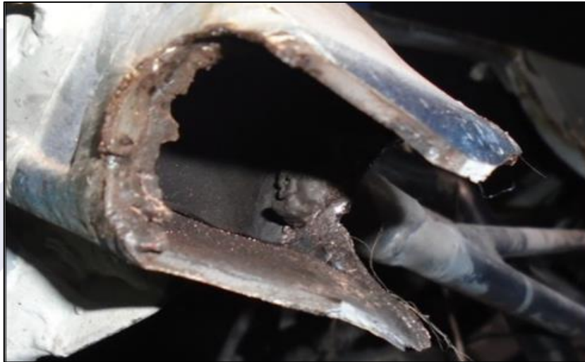
Figura 2 - Corrosão observada na região de fixação da asa.
