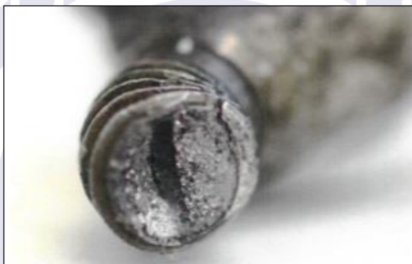
Figura 4 - Detalhe da região fraturada com característica de sobrecarga.
