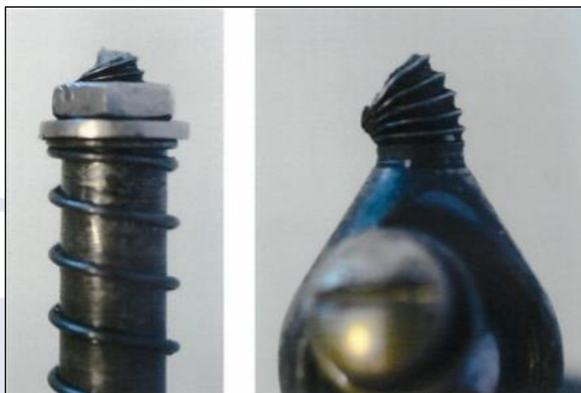
Figura 3 - Detalhe da região fraturada do Link Assembly - Nose Gear Dowlock .
