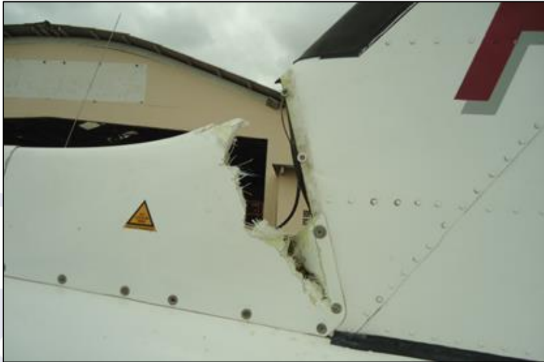
Figura 2 - Danos causados na deriva durante a remoção da pista.
