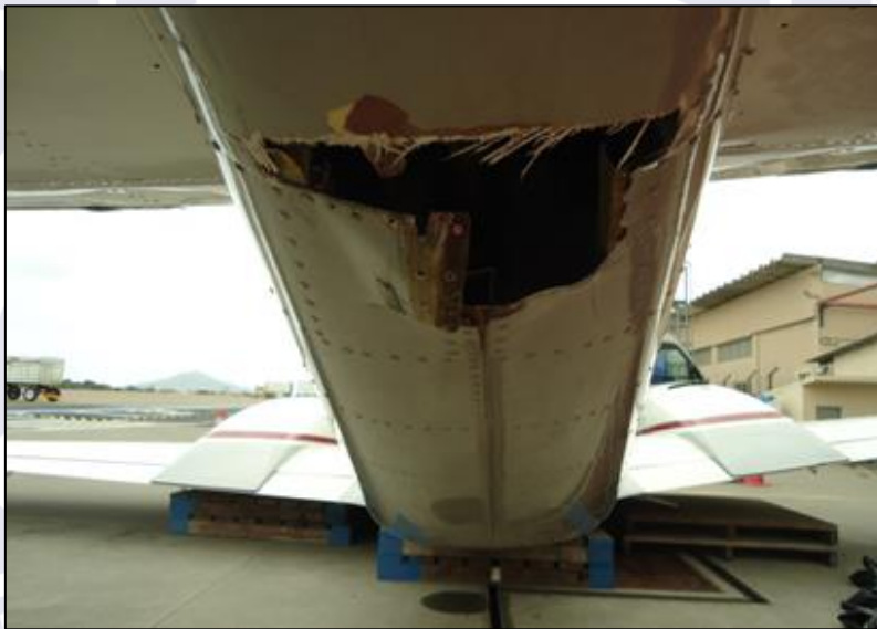
Figura 3 - Dano causado na carenagem inferior da fuselagem durante a remoção da pista.
