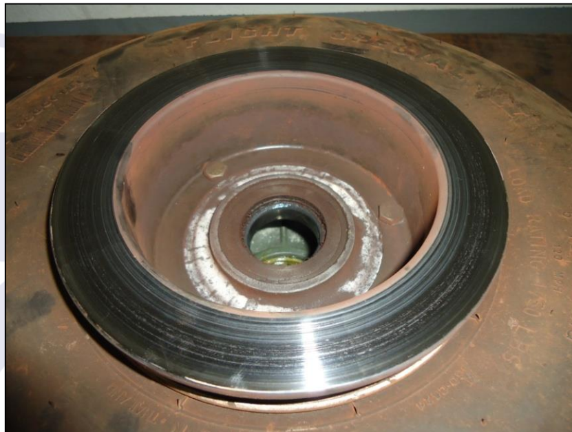
Figura 1 - Detalhe das marcas de atrito no disco de freio direito.
