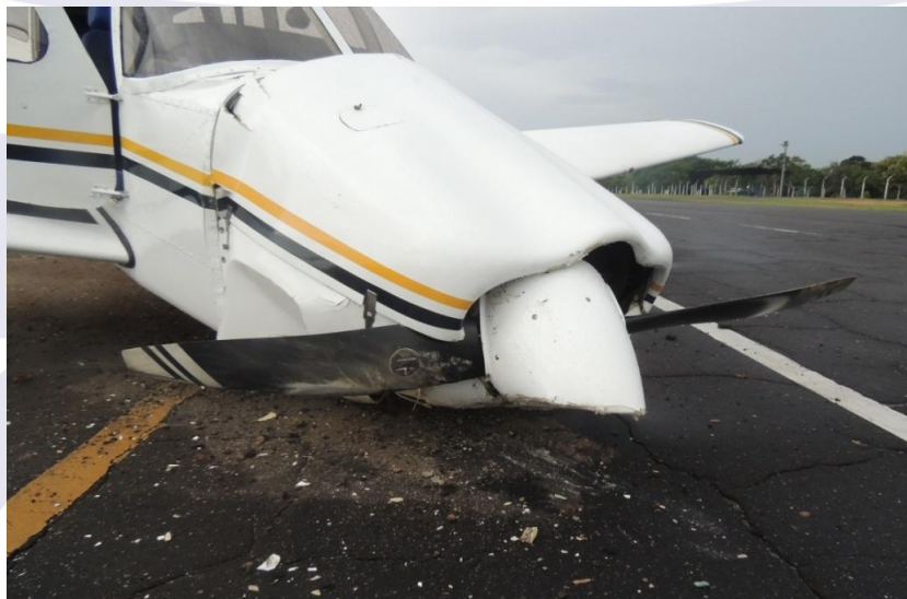
Figura 2 - Vista frontal da aeronave apresentando dano no nariz e na hélice.
