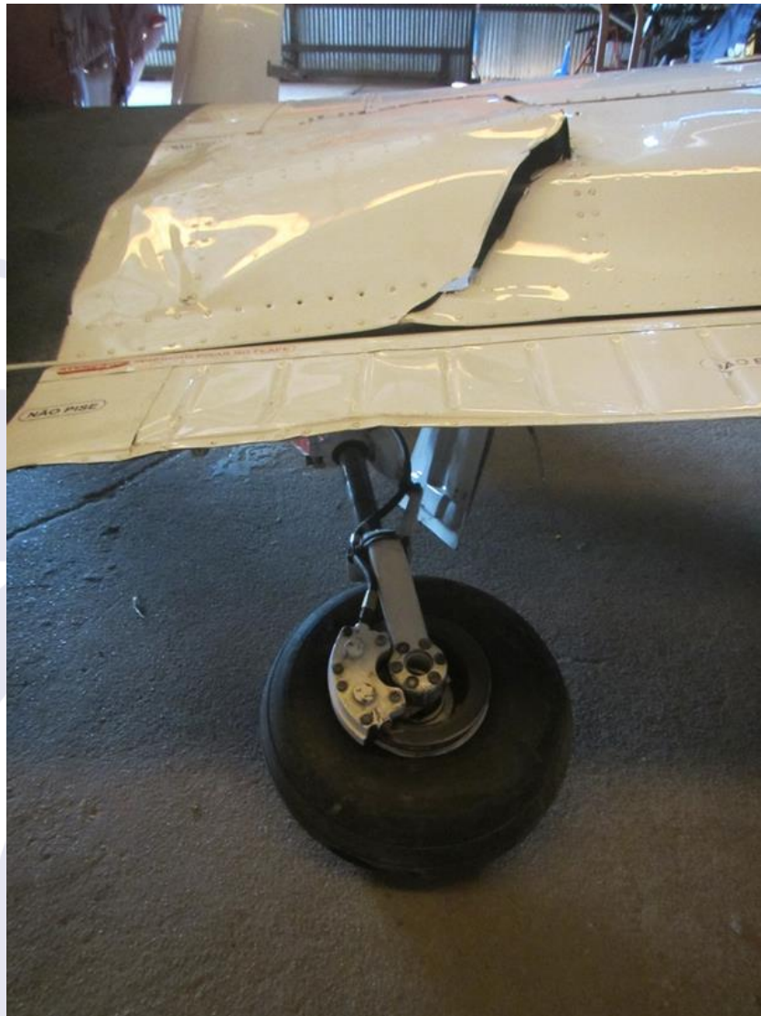
Figura 1 - Trem de pouso principal direito quebrado.
