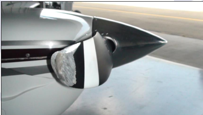
Figura 2 - Dano na ponta de uma das pás da hélice.
