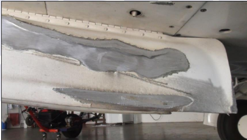
Figura 1 - Danos em uma das portas do trem de pouso de nariz do avião.
