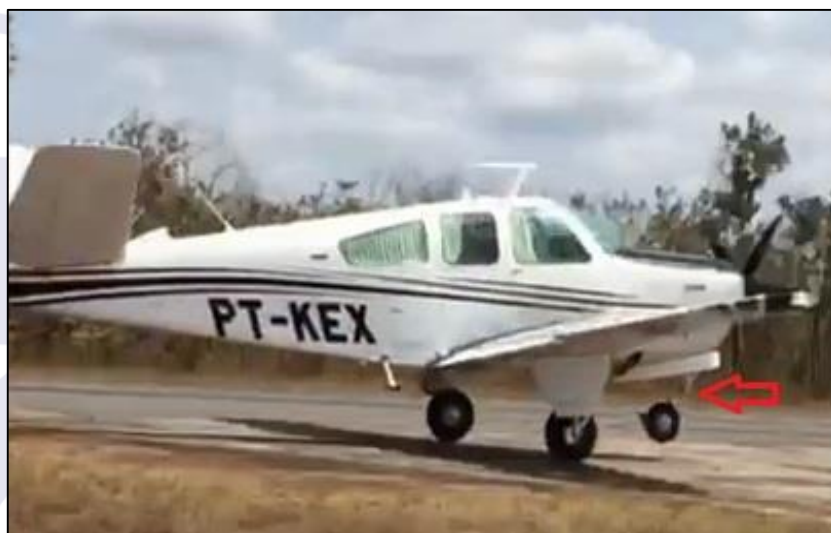
Figura 2 - Momento do pouso da aeronave, com destaque para o trem de pouso de nariz não travado. Fonte: observador.
