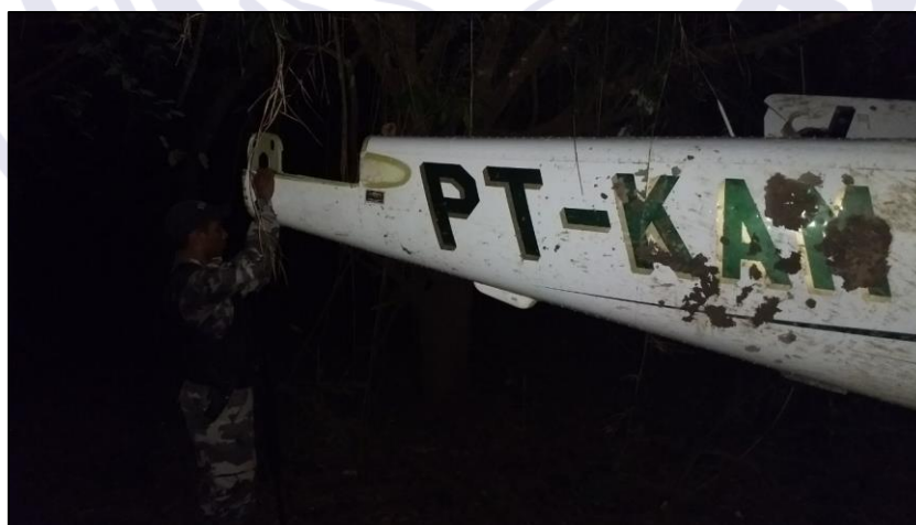
Figura 2 - Aeronave sem a empenagem.
