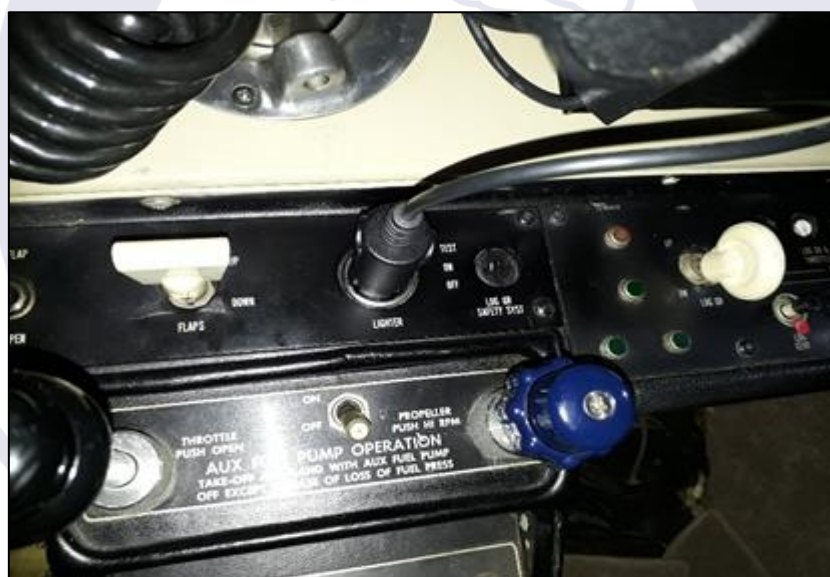
Figura 3 - Interruptores brancos de acionamento dos flaps e do trem de pouso.
