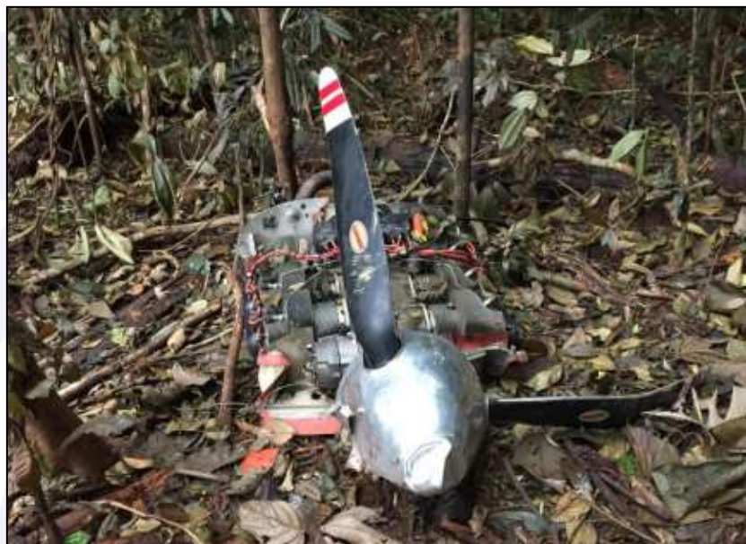
Figura 2 - Vista frontal do motor direito, sem indícios de fogo. Uma das pás foi removida por populares.
