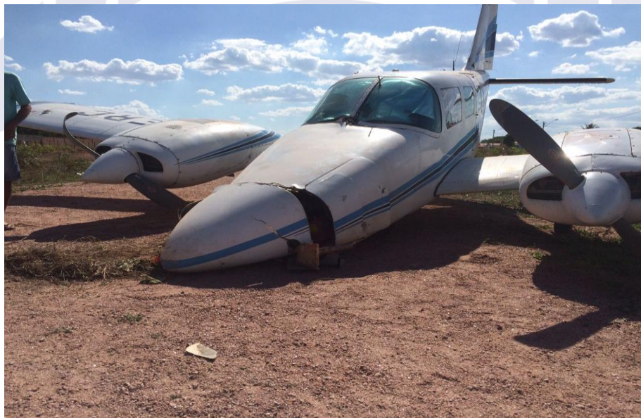
Figura 1 - Posição final da aeronave após o pouso em Coribe.
