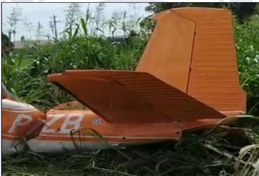
Figura 3 - Danos causados ao cone de cauda da aeronave.
