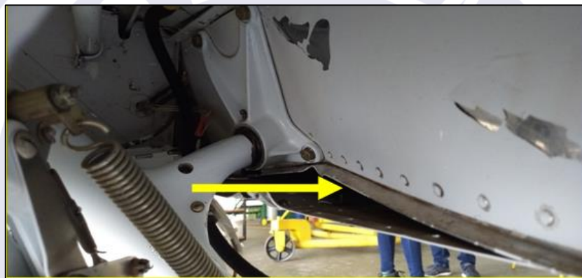
Figura 3 - Longarina traseira da asa onde era fixado o suporte traseiro do trem de pouso deformada para trás (seta).
