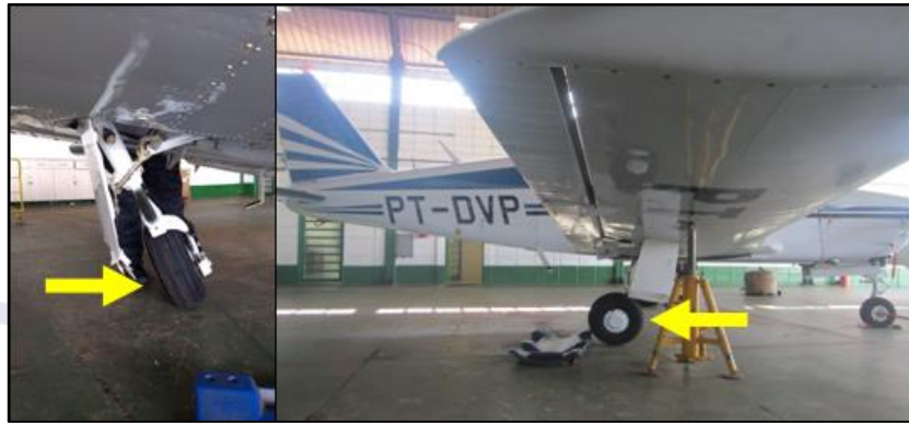
Figura 2 - Trem de pouso principal direito danificado. Quando apoiado em macaco hidráulico, notou-se o seu deslocamento para trás.
