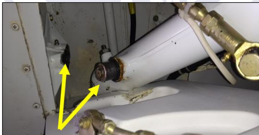
Figura 4 - Perna do trem de pouso desencaixada do suporte dianteiro, vista inferior. Pino de encaixe, à direita no detalhe, fora do suporte, à esquerda.
