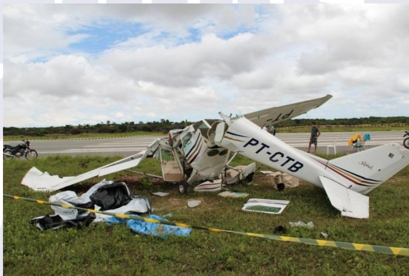
Figura 1 - Vista da aeronave com a cauda seccionada após colisão com o solo.
